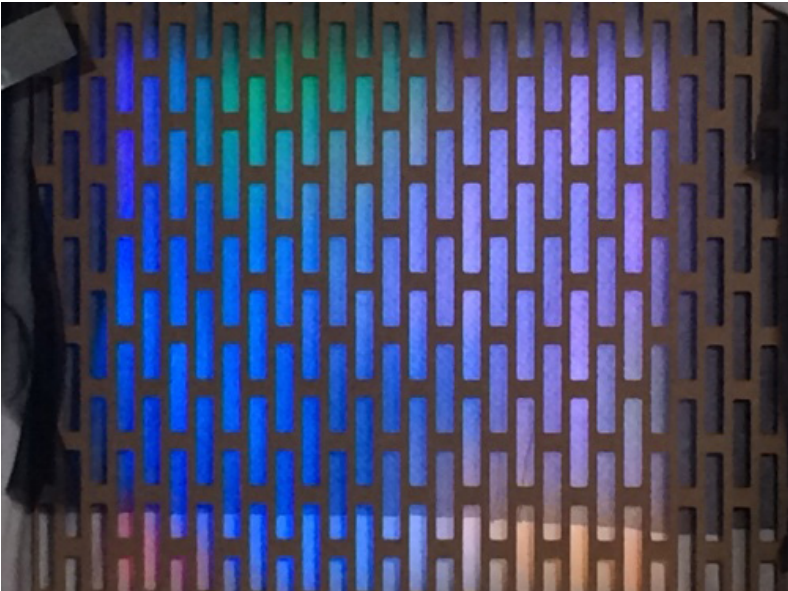
Fotografie podsvíceného vzorku panelu velikosti 70x70 cm, s podkladem difúzní a krycí látky (viz níže)
