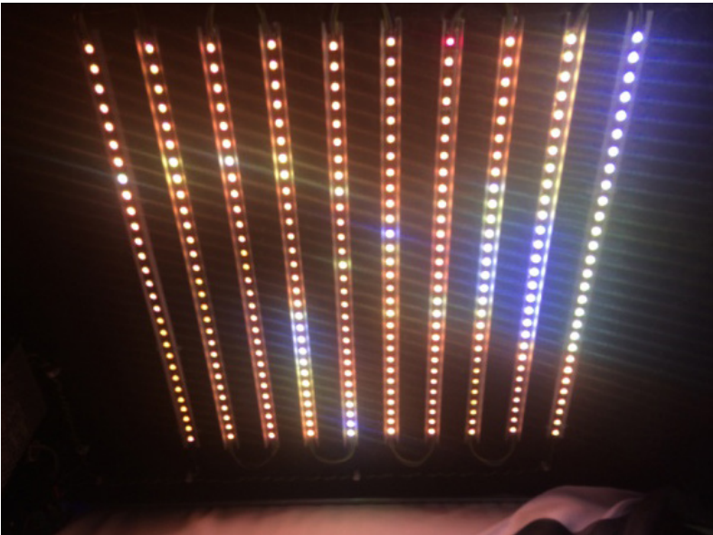
Systém LED pásků s rozlišením 60pix/m, pásky lepeny ve svislých hliníkových lištách osová vzdálenost lišt/LED pásků 50 mm
